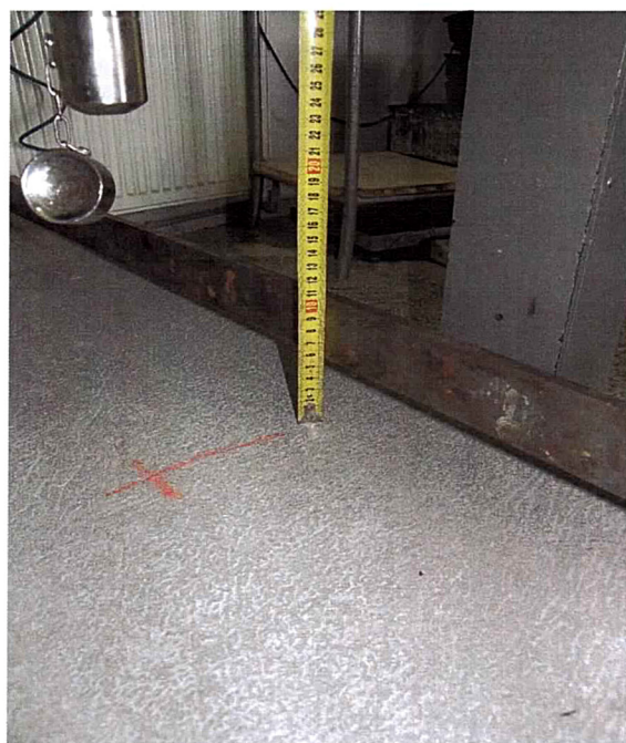
Obr. 4 Pohľad na trvalý priehyb dosky po skúške
