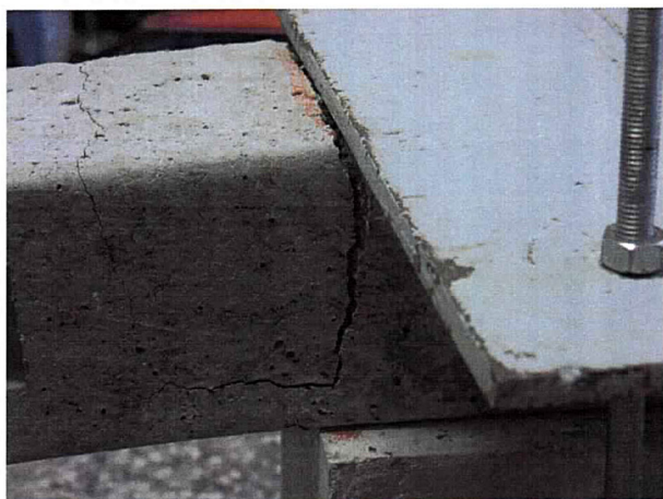
Obr. 12 Detail porušenia vzorky č.2 vo votknutí na medzi porušenia
