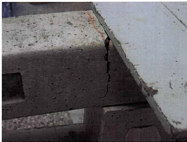
Obr. 13 Detail porušenia vzorky č.3 vo votknutí na medzi porušenia
