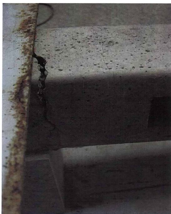
Obr. 10 Detail porušenia vzorky č.1 vo votknutí na medzi porušenia
